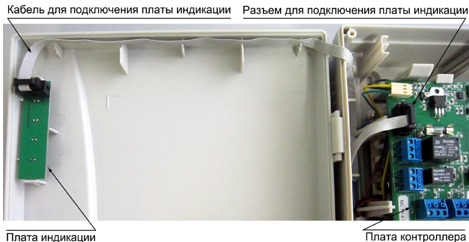
Рисунок 13. Подключение платы внешней индикации
