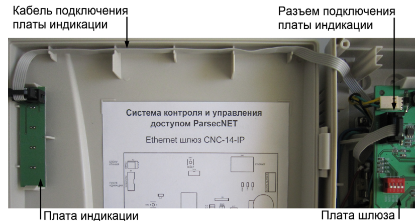
Рисунок 10. Подключение платы внешней индикации
