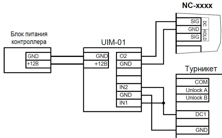
Рисунок 3. Подключение турникета с одним датчиком проворота
