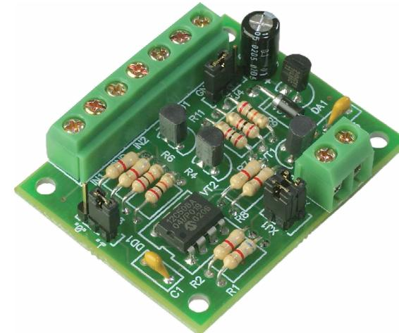
Рисунок 1. Плата модуля сопряжения с турникетами UIM-01
